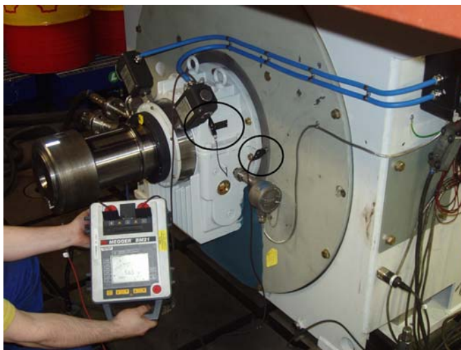
Figura 7-3 Medición de la resistencia de aislamiento de un cojinete cilíndrico
